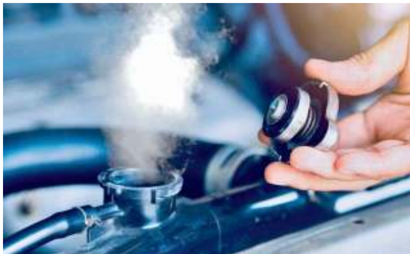
Bele usedline na pokrovčku in padec ravni hladilne tekočine v ekspanzijski posodi so zanesljiv znak, da gre tekočina tja, kamor ne bi smela.
